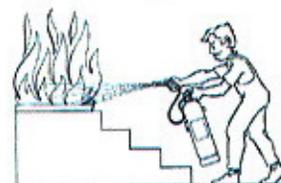
4. Dirigir el extinguidor a la base de las llamas del movimiento de barrido. En caso de presencia de llamas proceder a utilizarlo en el punto inferior abatiendo el fondo de la misma para evitar que se propague. Aproximarse lentamente al fuego hasta un máximo de 1 metro de él.
