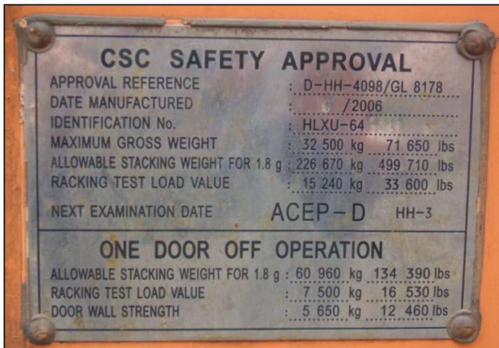
Fig.11- Placa de aprobación de seguridad de un contenedor-
